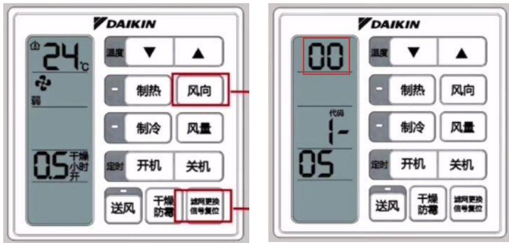
(2) 按“关机”键对“00”模式进行编辑，确定后“代码”处于闪烁状态。
