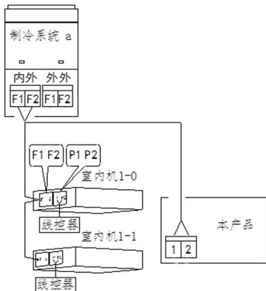
一套制冷系统联系示意图
